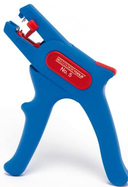
Die WEICON-Abisolierzange No. 5 kann alle flexiblen und massiven Leiter von 0,2 – 6,0 mm<sup>2</sup> abisolieren. Die Zange verfügt über einen verstellbaren Längenanschlag von 5 – 12 mm. Der Längenanschlag kann bei Bedarf herausgenommen werden. Ein gut zugänglicher Seitenschneider ist in das Werkzeug integriert, der bis zu einem Kabeldurchmesser von 2 mm genutzt werden kann. Die Klingen sind wechselbar. Das geringe Gewicht der No.5 sorgt für ein ermüdfreies Arbeiten.
